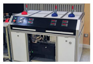
Система измерения электрических параметров ЭКБ под воздействием температуры «Терминал-Матрица»
