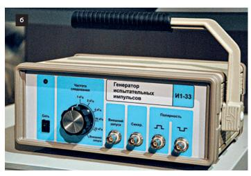
Разработано по собственной инициативе: а – измеритель параметров ферритовых сердечников кольцевой формы Ш1-23; б – генератор испытательных импульсов И1-33
