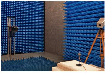
Установка при измерении методом вращения в горизонтальной плоскости
