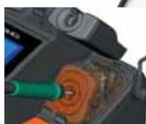
Новая система очистки картридж-наконечника, которая позволяет предотвратить разбрызгивание частиц припоя, поддерживая рабочую зону в чистоте.
