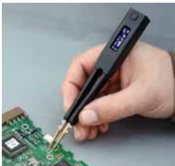
Smart Tweezers™ – портативный LCR-метр нового поколения. Smart Tweezers™ существенно облегчает решение задачи идентификации и измерения компонентов для поверхностного монтажа, а также при поиске неисправностей в сложных электронных приборах.
