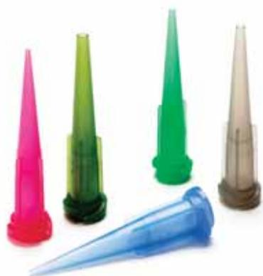
Конические иглы Серии TT изготовлены из полиэтилена с УФ-блокаторами. В основании конуса имеется втулка с люэровским соединением с двойной резьбой, что обеспечивает надежное присоединение к картриджу.
