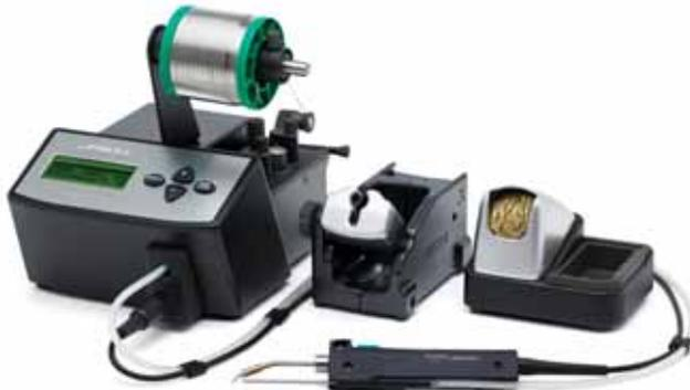
Станция AL с автоматической подачей припоя незаменима при проведении монтажных работ, когда требуются свободные руки. Автоматизированная подача трубчатого припоя в точку пайки является прекрасным дополнением к уникальным преимуществам паяльных станций JBC. Система состоит из электронного блока управления AL, моторизированной системы подачи трубчатого припоя, направляющей трубки и держателя катушки с припоем.
