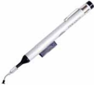
Антистатический вакуумный пинцет PEN-VAC имеет алюминиевый корпус длиной 146 мм. В комплект поставки входят 5 наклонных иглол с присосками 3,18 мм, 6,35 мм, 4,76 мм, 9,53 мм, 12,7 мм и 5 прямых иглол с присосками 3,18 мм, 6,35 мм, 4,76 мм, 9,53 мм, 12,7 мм. Присоски изготовлены из проводящей резины.
