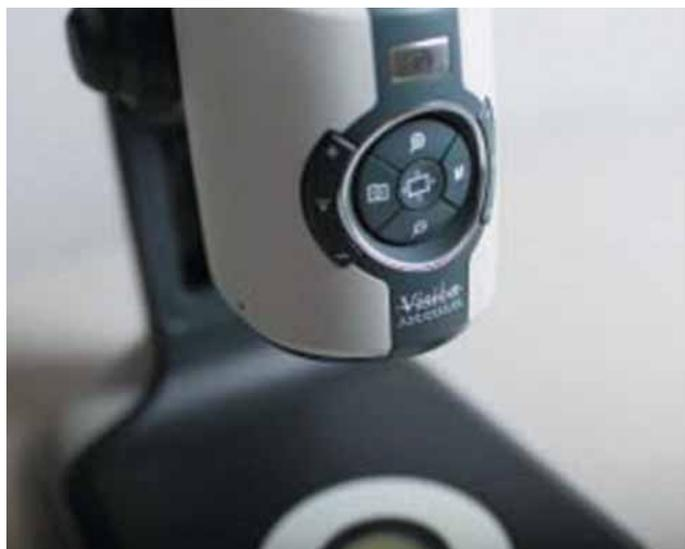
Встроенный светодиодный кольцевой осветитель с регулировкой интенсивности, светодиодное проходящее освещение (опция)
