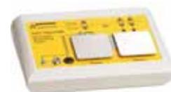
Когда PGT®120 в системе используется режим «Свободные руки», измерения проводятся последовательно через обувь, без прикосновения к электроду на тестере.
