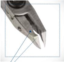
Инструментальная сталь легированная вольфрамом
