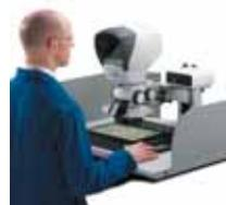
Модуль углового обзора позволяет просматривать изображение под углом 34° от вертикали, и проводить вращение точки обзора на 360° вокруг объекта, получая превосходное трехмерное стереоизображение объекта со всех сторон.
